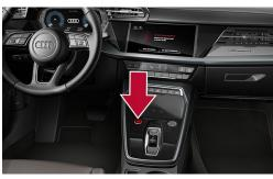
"Start-Engine-Stop"-Taste in der Mittelkonsole drücken ohne Fußbremse zu betätigen
