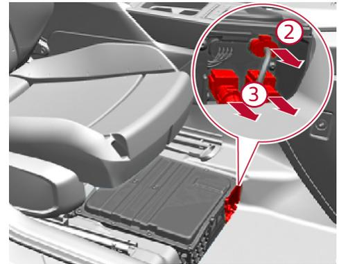
Bei Unfällen mit Airbagauslösung wird das 48-Volt Bordnetz automatisch deaktiviert.
