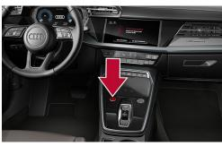
Appuyer sur la touche « Start-Engine-Stop » dans la console centrale sans actionner la pédale de frein
