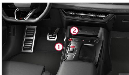
1. Premere il tasto di parcheggio "P" e azionare il freno di stazionamento.
